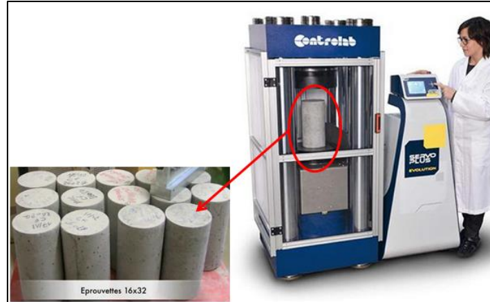
Figure. 1.6. Essai de compression sur éprouvette cylindrique
