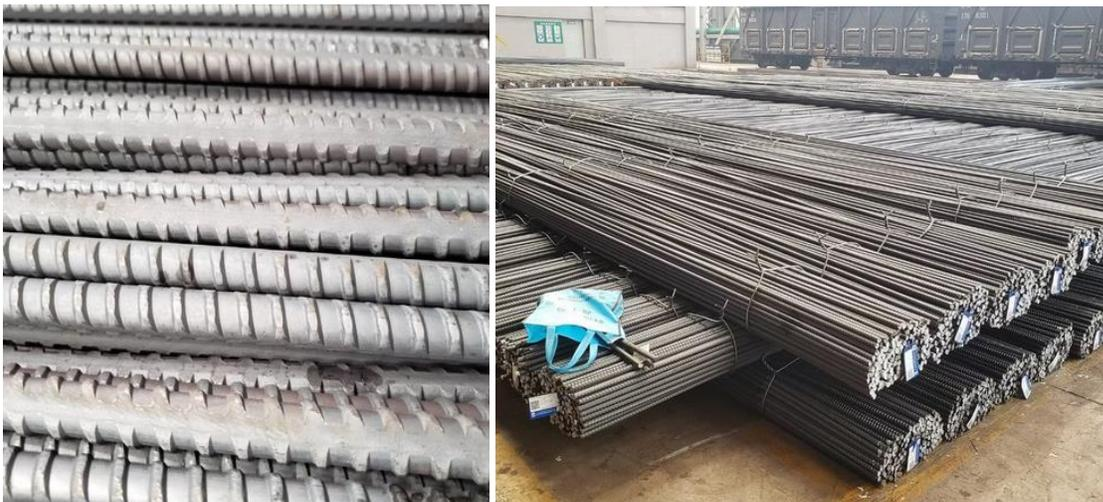
Figure. 2.7. Barres utilisées dans la précontrainte
