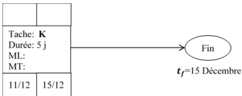
Figure 4.6. Exemple de calcul des dates au plus tard d'une tâche située à la fin
