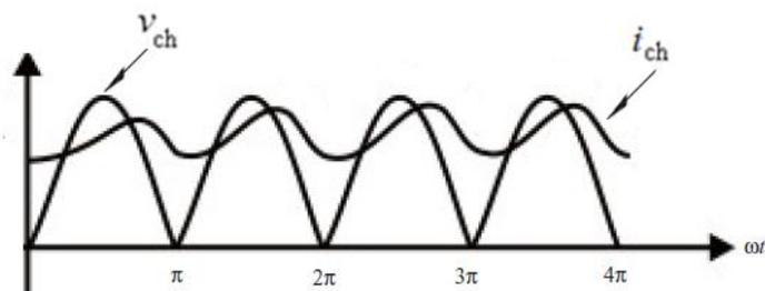
**Allures du courant et de la tension pour P2 (charge RL)**
