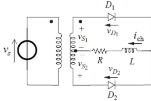
Comme pour le montage redresseur simple alternance avec charge RL les diodes se bloquent avec l'annulation du courant qui est en retard par rapport à la tension dû à la nature inductive de la charge.
