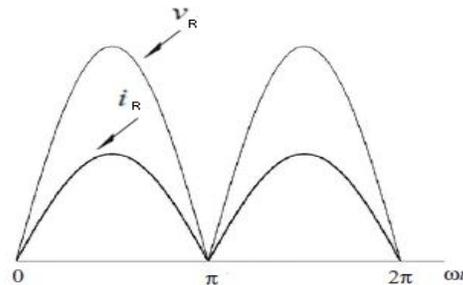
Allures du courant et de la tension pour P2 (charge R)
