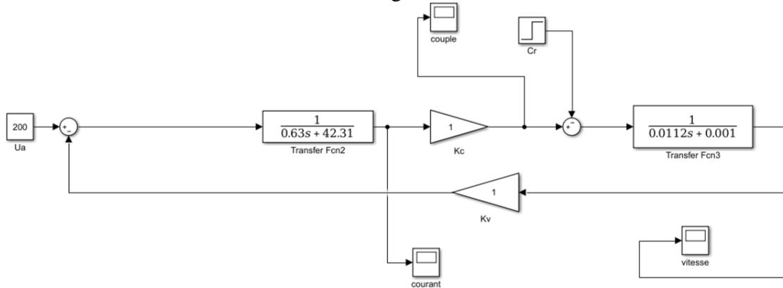
1. Implémenter sur **Simulink** le schéma bloc qu'on pourra nommer **essai1** représentatif de la MCC. Avec  $U=200V$  et  $Cr=1Nm$ .
