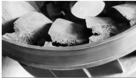
Figure: Dégâts par cavitation
