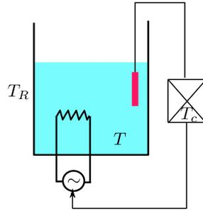
FIGURE 1.2 – Schéma général du dispositif. Le bain doit être amené et maintenu à température de consigne  $T_c$ , tandis que la température de la chambre est à  $T_R$ . La température du bain peut être augmenté en faisant passer un courant électrique dans une résistance à l'intérieur du bain. Un automate mesure constamment la température du bain  $T$  à l'aide d'une sonde, la compare à la consigne  $T_c$  et régule la tension du générateur électrique.
