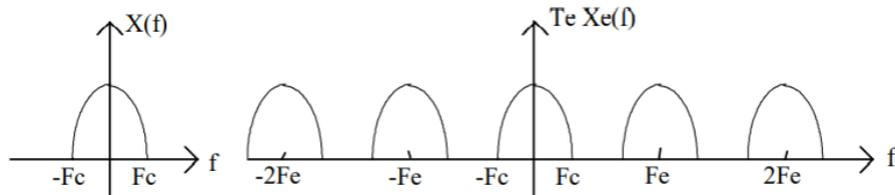
On constate qu'au prix d'un simple filtrage passe-bas idéal, de fréquence de coupure  $F_e / 2$  on retrouve  $X(f)$ , donc  $x(t)$ :
