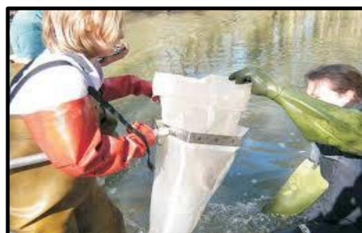
**Figure 1** : Prélèvement de macroinvertébrés à l'aide d'un filet SURBER
