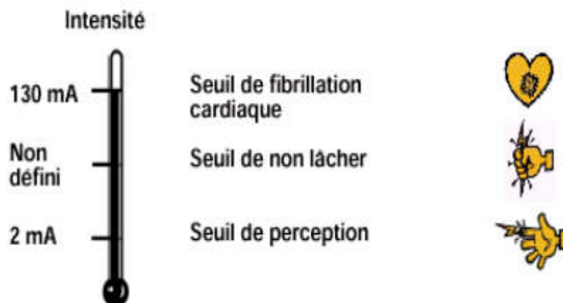
Figure II.2 : Seuils de danger du courant électrique continu
