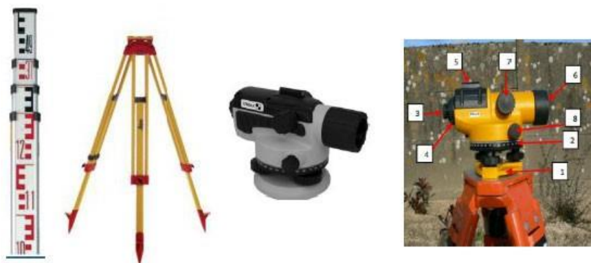
Fig. V.2 Matériels utilisés en nivellement
