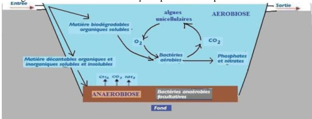
**Figure 3 :** Schéma de fonctionnement d'épuration par lagunage.
