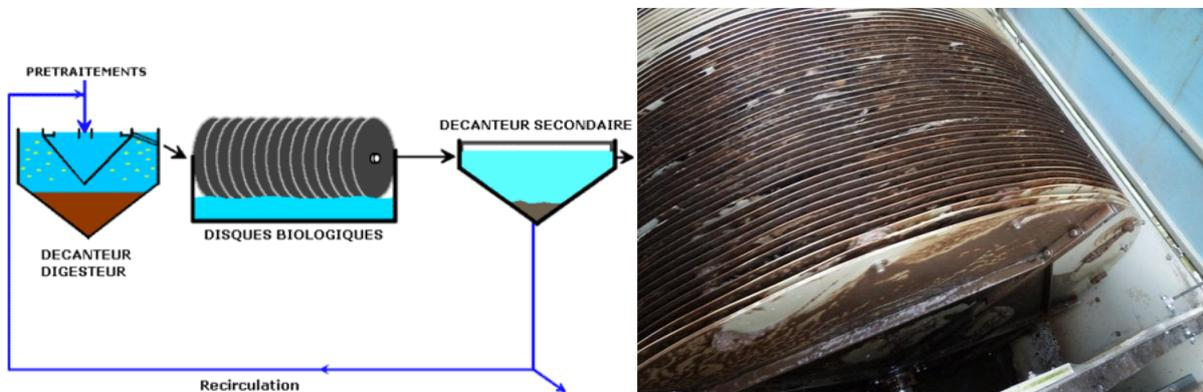
Figure 6 : Schéma du principe de fonctionnement - Disque biologique.
