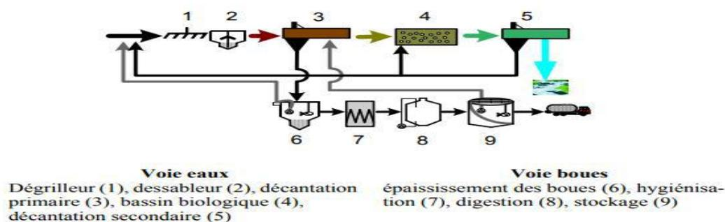
Figure 02 : Schéma simplifié d'une STEP.
