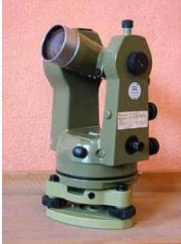
Le tachéomètre y ajoute la possibilité de mesurer des distances. Auparavant, les instruments étaient analogiques (lecture sur un cercle vertical et un cercle horizontal pour les angles et mesure optique de la distance). Actuellement on utilise des appareils électroniques : la mesure est indiquée directement en chiffres sur l'écran (lecture digitale). La mesure de distance est permise par l'incorporation à la lunette d'un distancemètre électronique (EDM Electro-Optical DistanceMeter)
