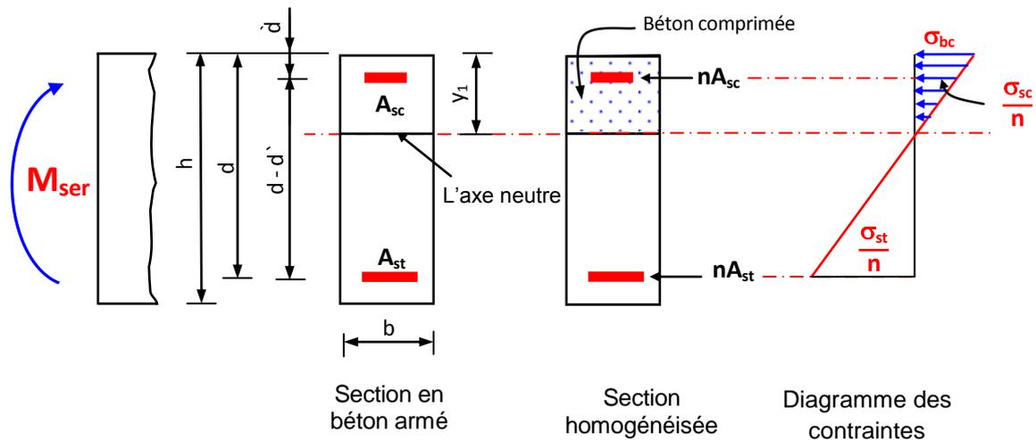
Fig. 4.12 : Section rectangulaire avec armatures comprimées.
