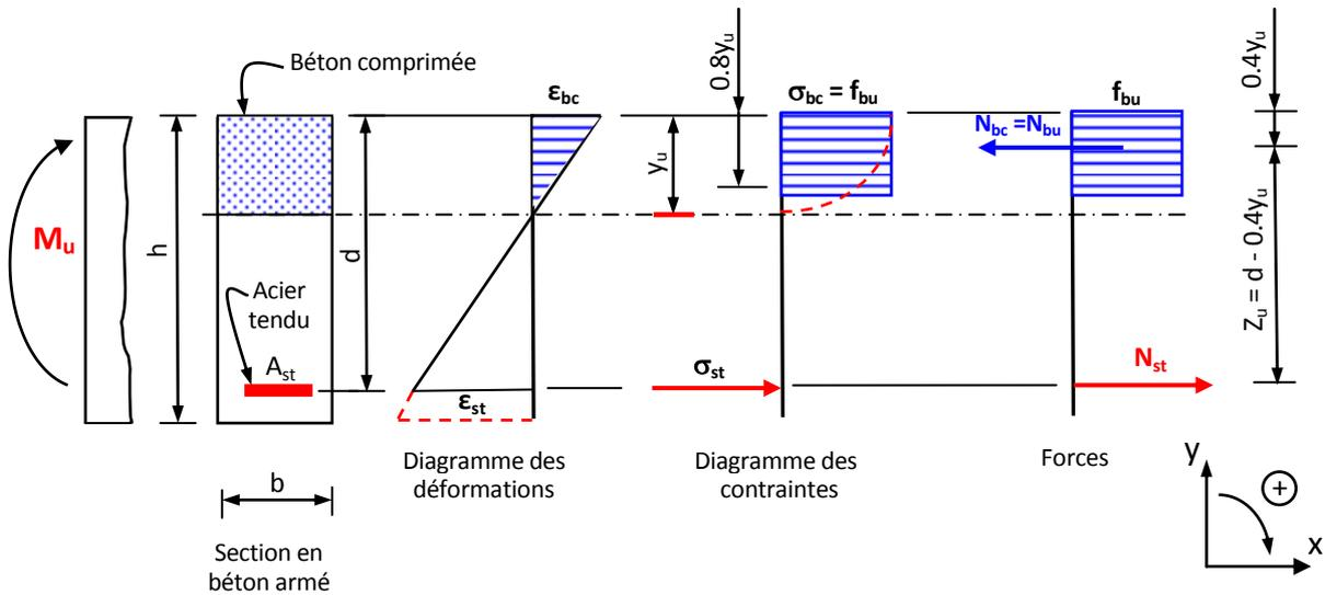
**Fig. 4.4 :** Diagrammes contrainte-déformation parabolique-rectangulaire et rectangulaire simplifié dans la section de béton comprimé
