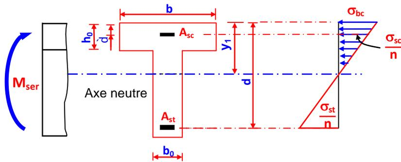
**Fig. 4.13 :** Section en T avec armatures comprimées.
