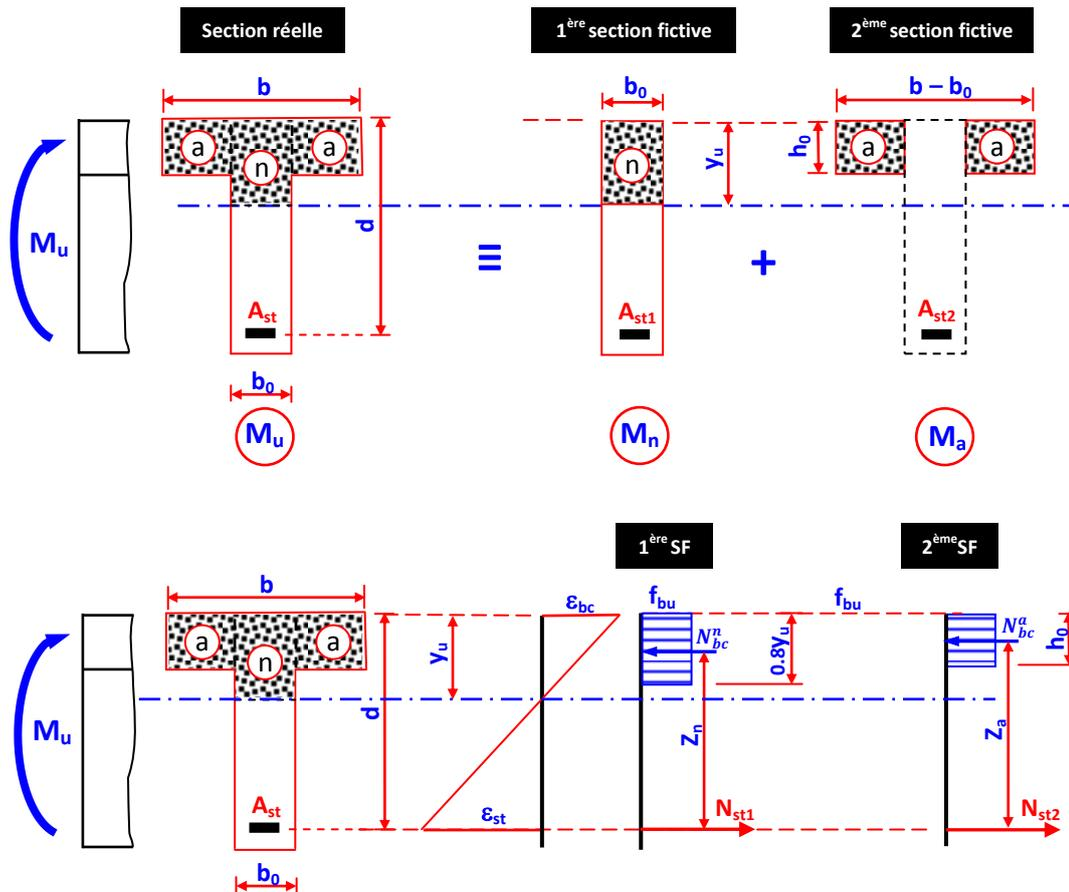
Fig. 4.9: Principe de calcul à l'ELU d'une section en T, avec :  $M_t < M_u$
