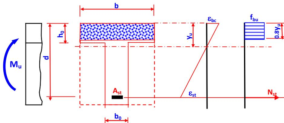
Fig. 4.8: Principe de calcul à l'ELU d'une section en T, avec :  $M_t \geq M_u$
