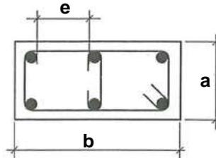
**Fig. 3.8 :** L'espace entre les armatures longitudinales
