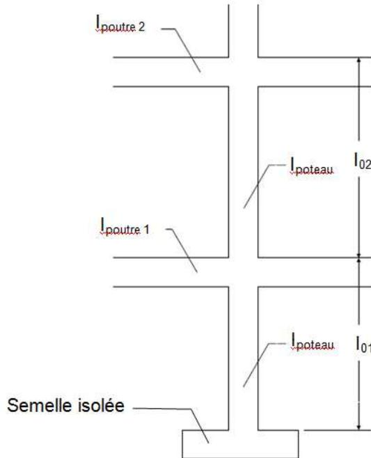
**Fig. 3.4 :** Longueur de flambement pour un bâtiment
