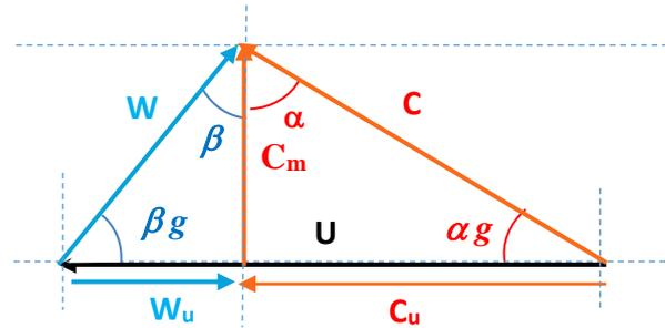
Le triangle des vitesses d'une machine radiale et les composants (Tangentielle, radiale)
