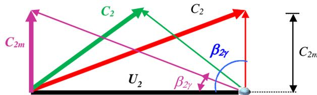
Cette figure illustre pour  $u_2 = cte$ . Pour une plage limitée la dépendance du degré de réaction  $R=f(c_{2u})$  avec l'angle d'inclinaison des aubes  $\beta_{2g}$ .
