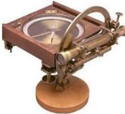
Un clisimètre est un instrument utilisé par les topographes, constitué d'un petit pendule. Le clisimètre permet aux topographes de mesurer avec une grande précision l'inclinaison d'une pente
