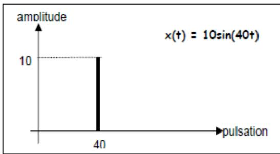
**Spectre d'un signal sinusoïdal**
