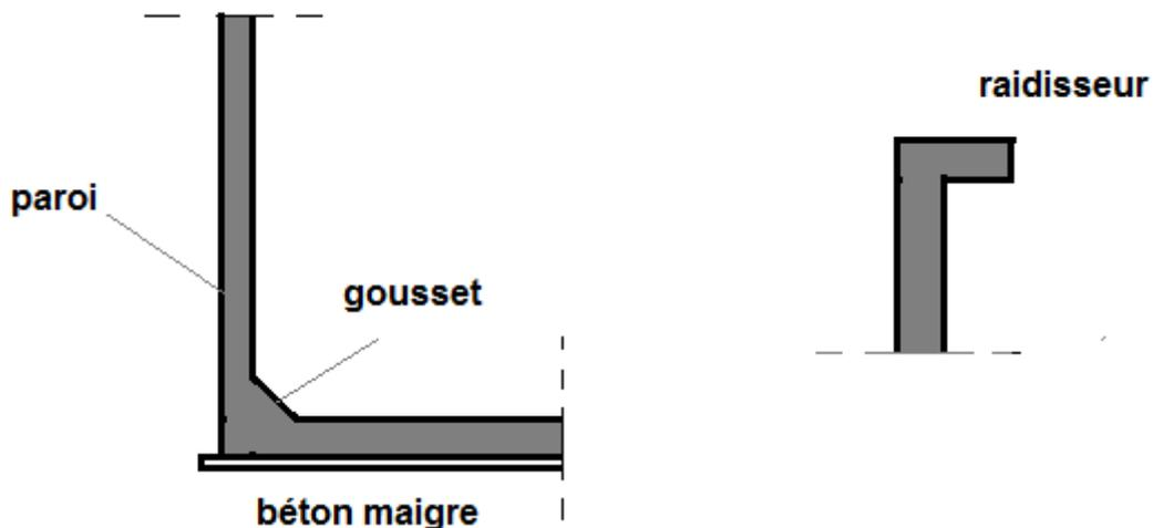
**6.1.2 : Bassins de grandes dimensions horizontales :** le radier peut être réalisé de différentes façons. Les charges des parois peuvent être réparties sur le sol par **un radier plus ou moins épais** ou par **un radier nervuré**. On préfère généralement le radier épais bien qu'il conduira à un volume important de béton car le tassement est beaucoup plus simple. Les parois peuvent être d'épaisseur variable, c'est la solution la plus simple.
