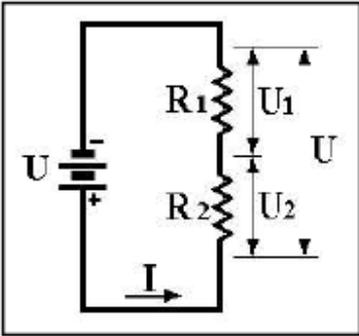
$$R_S = R_1 + R_2 + \dots \quad (3)$$
