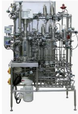
Bioréacteur de laboratoire stérilisable à l'autoclave Tryton™ (1 à 18 L)
