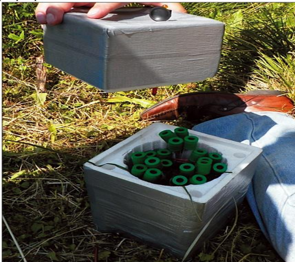
Fig. 3. La température dans la chambre d'incubation est stable, elle est remplie d'eau et permet un ajustement rapide de la température. La température est réglée et ajustée à un niveau constant pendant toute la durée de l'incubation en utilisant des glaçons ou de l'eau chaude.
