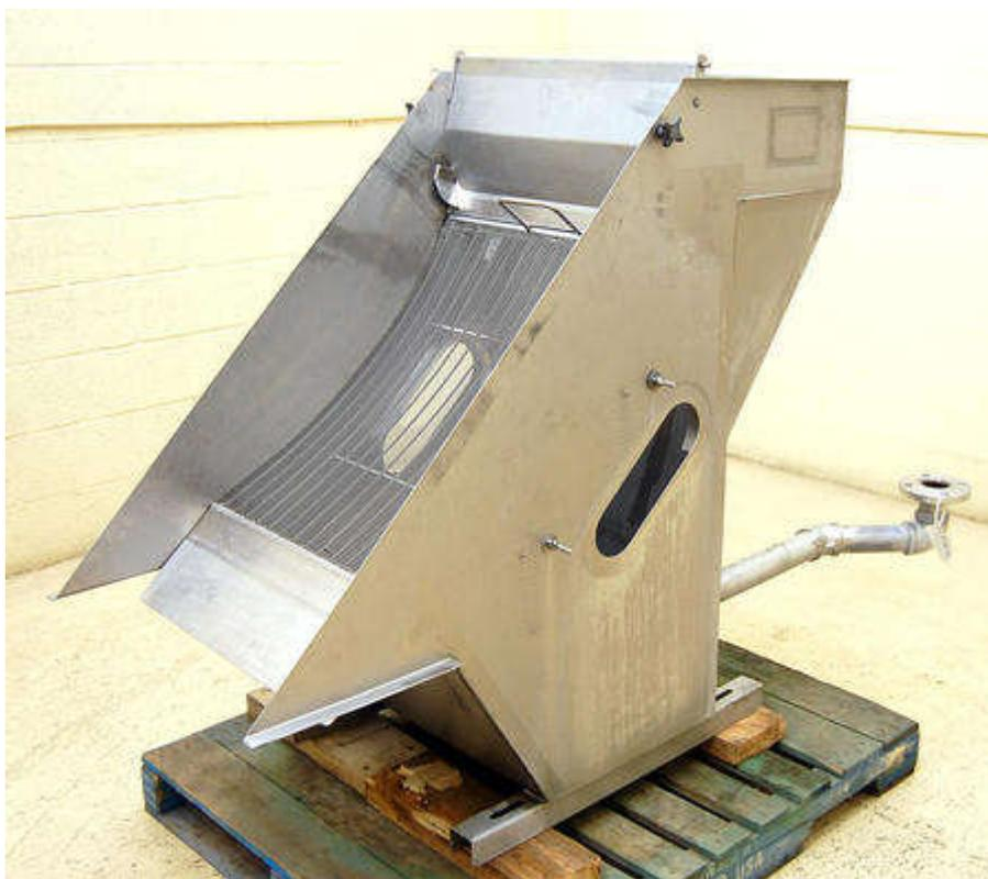
**Figure 07 :** Tamis statique type Hydrasieve.
