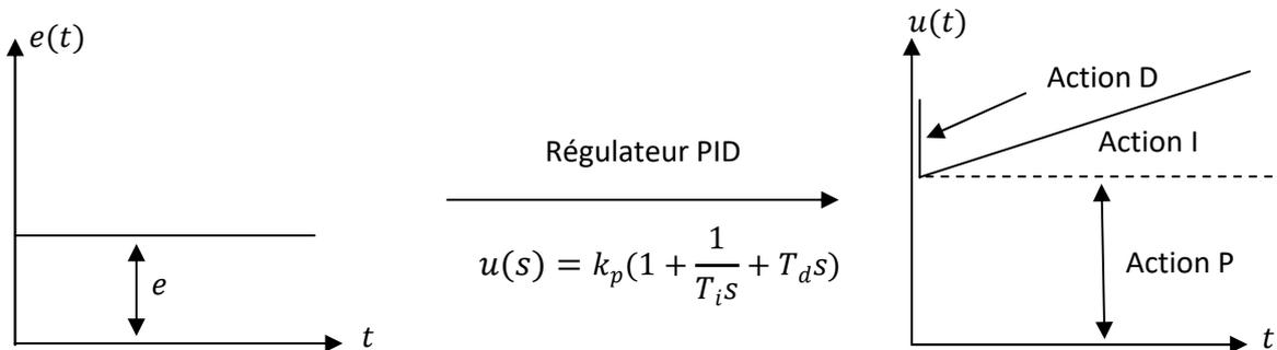
3.4. Structures des régulateur PID
