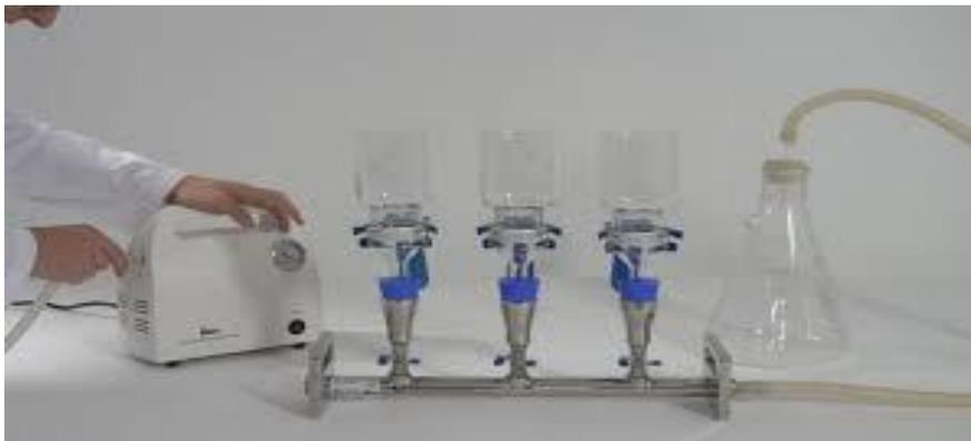
Figure 3 : Filtration sur membrane microbiologique
