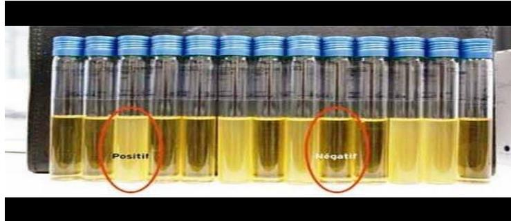
Figure 7 : Dénombrement à essai multiple.
