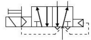
5/2 à c<sup>de</sup> électropneumatique (représentation des pilotages internes . DIFFERENTIEL), à section prioritaire, bistable et c<sup>de</sup> manuelle de secours
