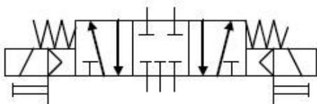
5/3 à c<sup>de</sup> électropneumatique, centrage par ressorts et c<sup>des</sup> manuelles de secours, centre fermé
