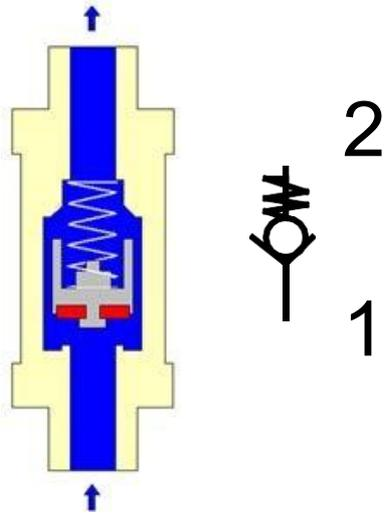
Les clapets anti-retour peuvent interdire complètement le débit dans un sens cependant que dans l'autre sens l'air comprimé passe avec une perte de charge aussi réduite que possible
