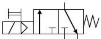
3/2 à c<sup>de</sup> électropneumatique, rappel par ressort et c<sup>de</sup> manuelle de secours
