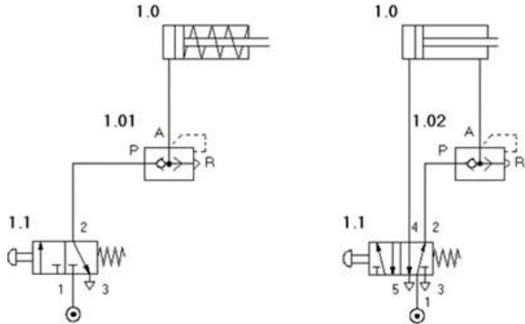
Les soupapes d'échappement rapide servent à augmenter la vitesse du piston sur les vérins. On évite le temps de retour long, notamment sur les vérins à simple effet. La tige du vérin peut sortir pratiquement à pleine vitesse en raison de la résistance réduite à l'échappement pendant la rentrée de la tige. L'air est évacué par un orifice d'échappement relativement important. Ce clapet dispose d'un orifice de pression P qui peut être obturé, d'un échappement R et d'une sortie A.
