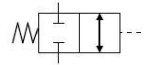
2/2 à c<sup>de</sup> pneumatique directe, monostable, NF (bloqueur)
