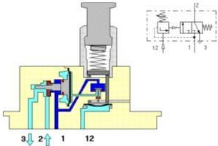
Cette soupape fonctionne sur le même principe que le limiteur de pression. Elle s'ouvre lorsque la pression dépasse la limite réglée sur le ressort. L'air s'écoule de 1 (P) vers 2(A) . La sortie 2(A) ne s'ouvre que lorsque la conduite de commande 12(Z) a atteint sa pression pré-réglée. Un piston de commande ouvre alors le passage 1 (P) vers 2(A) .
