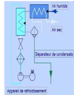
Le point de rosée est la température à laquelle l'humidité contenue dans l'air commence à se condenser. Plus le point de rosée est bas, moins l'air comprimé contient d'eau. Le séchage par le froid permet d'atteindre des points de rosée compris entre 2°C et 5°C.
