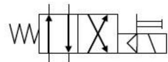
4/2 à c<sup>de</sup> électropneumatique, rappel par ressort et c<sup>de</sup> manuelle de secours
