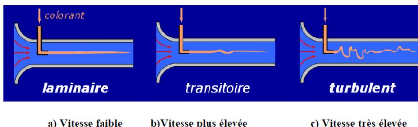
\*Pour des vitesses faibles, le filet colorant traverse le long de la conduite en position centrale.
