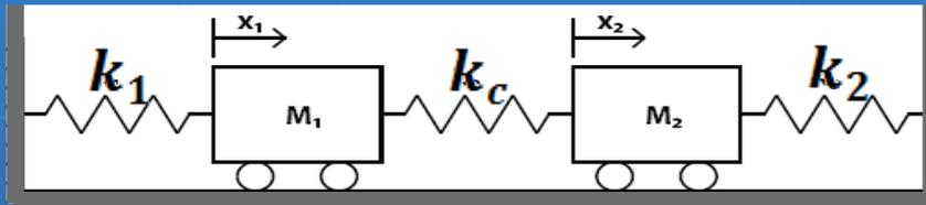
$$\begin{bmatrix} m_1 & 0 \\ 0 & m_2 \end{bmatrix} \begin{bmatrix} \ddot{x}_1 \\ \ddot{x}_2 \end{bmatrix} + \begin{bmatrix} k_1 + k_c & -k_c \\ -k_c & k_2 + k_c \end{bmatrix} \begin{bmatrix} x_1 \\ x_2 \end{bmatrix} = \begin{bmatrix} 0 \\ 0 \end{bmatrix}$$
