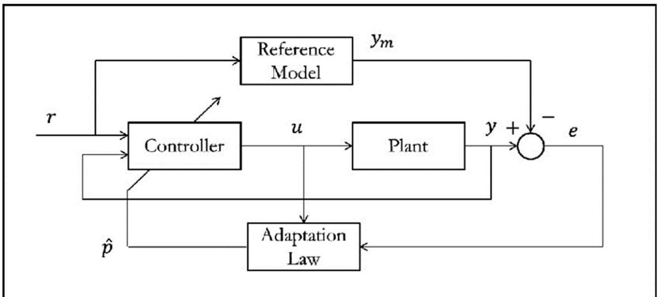
Soit  $H(s) = \frac{s+b_0}{(s+a_0)(s+a_1)}$  est la fonction de transfert du système à commander tel que  $a_0, a_1$  et  $b_0$  sont des constantes positives, et soit  $H_m(s) = \frac{s+1}{s^2+2s+2}$  est le modèle de référence.
