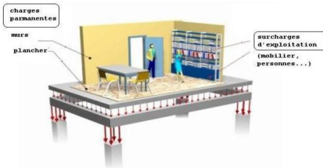
**Figure 5.1** : Répartition des charges sur les poutres de plancher [14].
