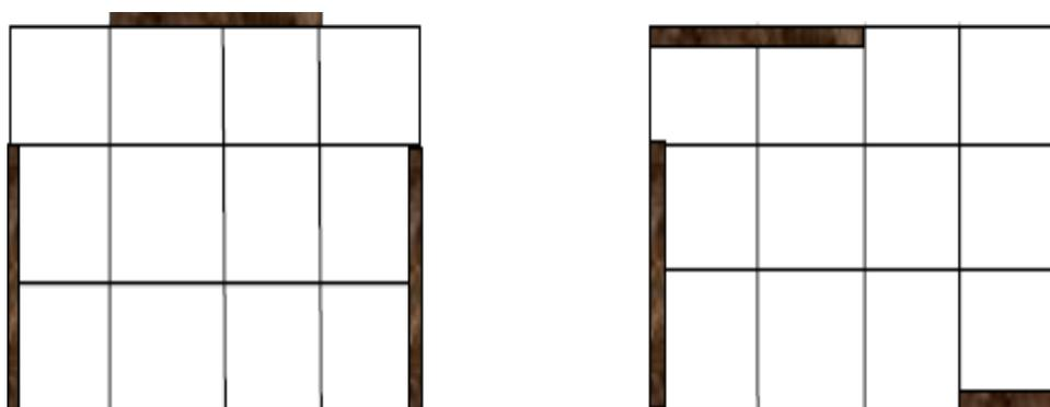
**Figure 4.14 :** Nombre minimal d'éléments verticaux de contreventement : deux pour s'opposer aux translations du -diaphragme respectivement dans les directions  $x$ ,  $y$ , et un troisième produisant avec l'un des deux autres, un couple résistant à la torsion d'axe vertical [13].
