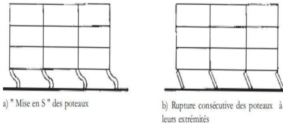
Figure 4.11 : Comportement des niveaux " souples " sous charges sismiques [13].
