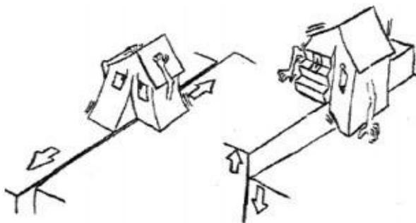
**Figure 4.1 :** Déplacements relatifs des lèvres d'une faille [13].
