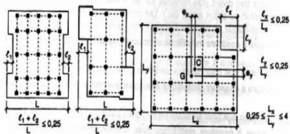
Figure 4.9: Irrégularité en plan RPA99/V 2003 [5].
