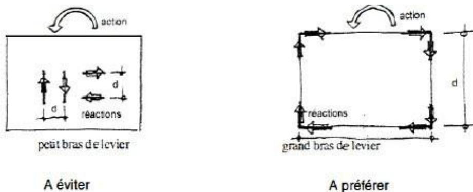
**Figure 4.16 :** Distance entre les éléments de contreventement. Une grande distance entre les éléments parallèles favorise la résistance de la structure à la torsion grâce à un bras de levier important dans le plan horizontal [13].
