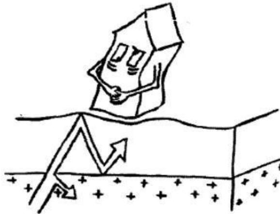
**Figure 4.3 :** Fondation sur sol meuble. Des mouvements sismiques de forte amplitude sont fréquents, de même qu'une amplification par effet de site dans le cas de fortes épaisseurs de couches compressibles [13].
