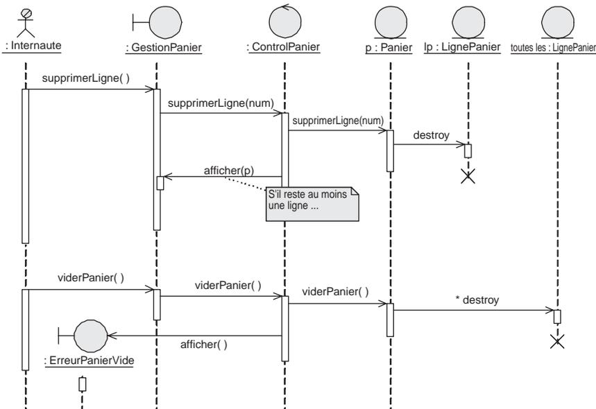
Figure C-28 Diagramme de séquence d'un scénario de vidage du panier
