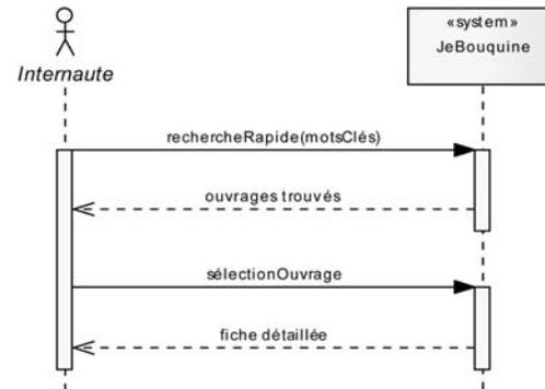
UML 2 fournit quelques notations complémentaires très utiles. Des rectangles, appelés fragments d'interaction, sont ainsi utilisables pour indiquer qu'un groupe de messages est optionnel (mot-clé opt), répété (mot-clé loop) ou alternatif (mot-clé alt). Nous avons utilisé ces nouvelles notations sur la figure 4-12 pour indiquer que :
