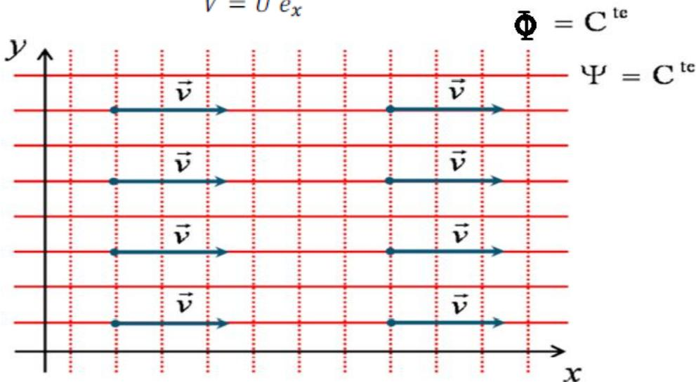
Figure I-13 Ecoulement rectiligne uniforme de vitesse  $U$
