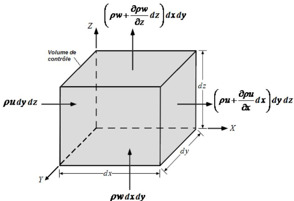
figure I-5 Volume de contrôle d'un élément fluide parallélépipédique
