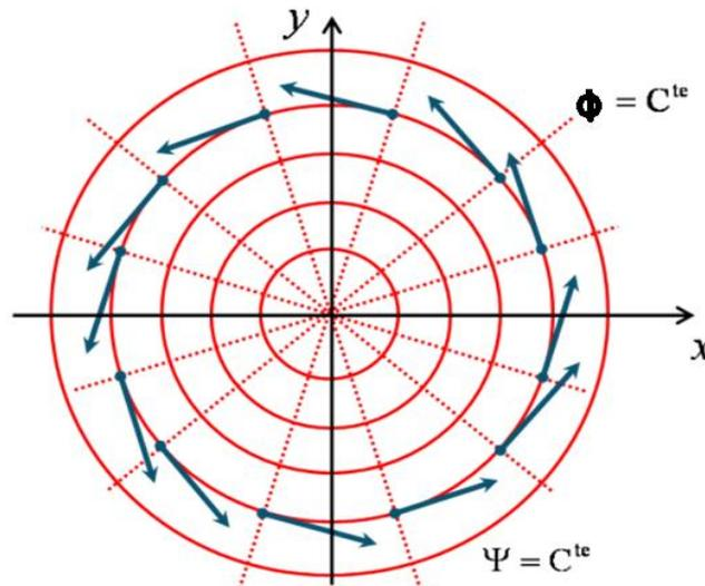
**Figure I-15: écoulement orthoradial**
