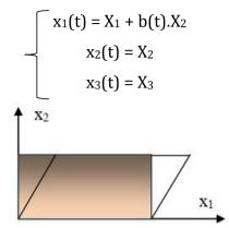
Figure 4. Cisaillement simple
