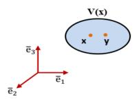
Figure 7. Voisinage d'un point matériel
