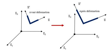
Figure 9. Déformation d'un élément (variation de longueur)
