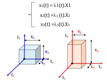
Figure 5. Déformation cubique d'un milieu continu
