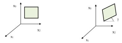
Figure 2. Exemple de déformation angulaire (distorsion)
