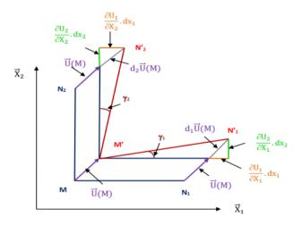
Figure 10. Eléments non diagonaux du tenseur de déformation
