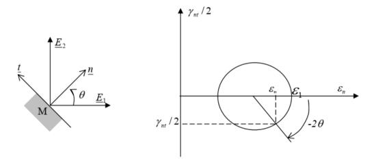
Figure 13. Cercle de Mohr des déformations
