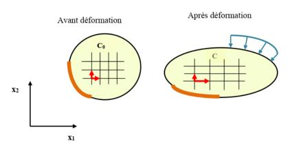
Figure 3. Exemple de déformation d'un milieu continu
