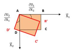
Figure 12. Rotation rigide dans un plan
