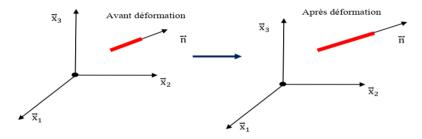
Figure 8. Déformation d'un élément
