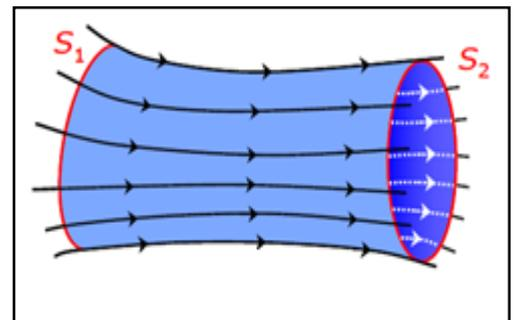
Fig. (II.5) : Tube de courant
