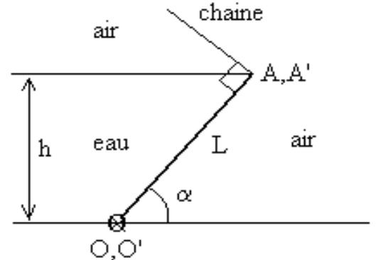
2) calculer les efforts transmis aux chaînes (on négligera le poids propre de la vanne) et la réaction de l'axe  $OO'$ .
