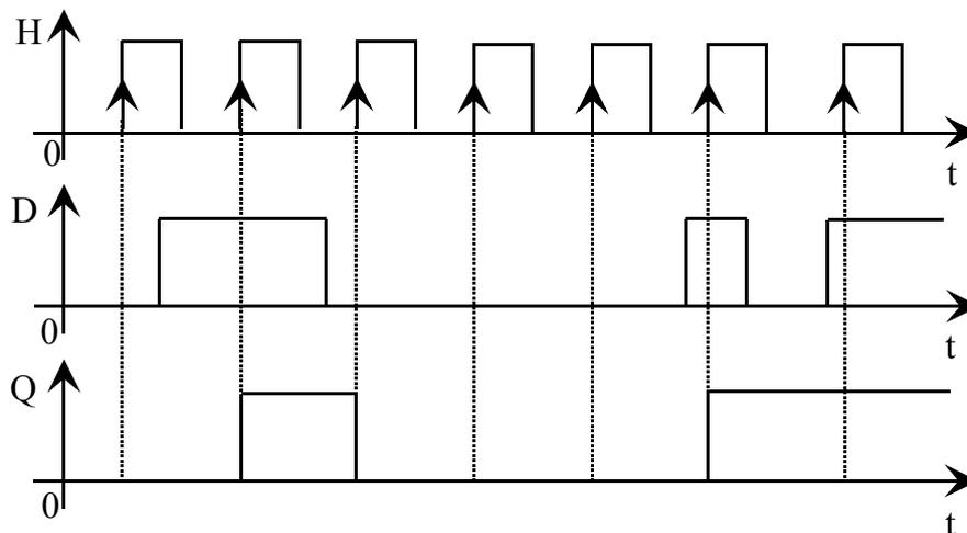
Dans le cas d'une bascule D à commande par front montant, nous pouvons dire que Q recopie D lorsque H devient égale à 1 (et lorsque H devient égale à 0 pour une bascule D à commande par front descendant).
