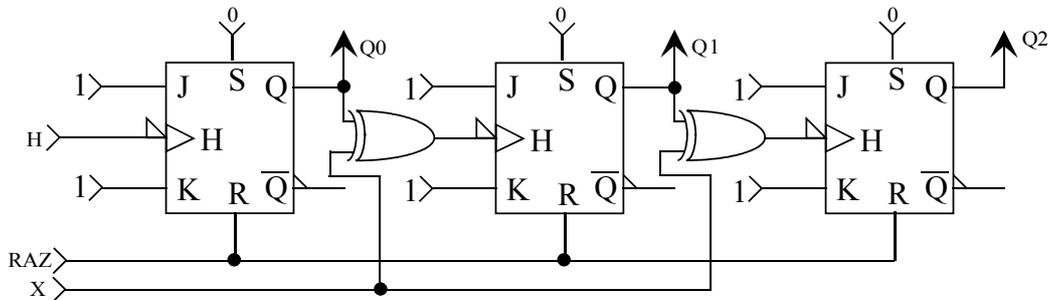
♦ **Compteurs asynchrones à modulo  $< 2^n$**  (Exemple : compteur asynchrone modulo 6) Ce compteur compte de 0 à 5.  $\Rightarrow$  **solution** : forçage par les entrées R (Reset)
