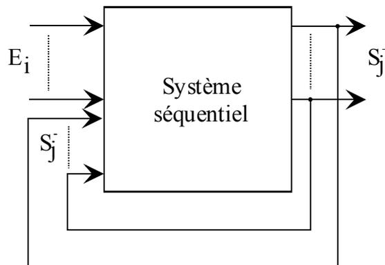
Nous voyons apparaître sur le schéma ci-dessus les symboles  $S_j^+$  et  $S_j^-$ . Le symbole  $S_j^-$  correspond à l'état des sorties avant l'évolution des entrées  $E_i$  et le symbole  $S_j^+$  correspond à l'état des sorties après l'évolution des entrées  $E_i$ .
