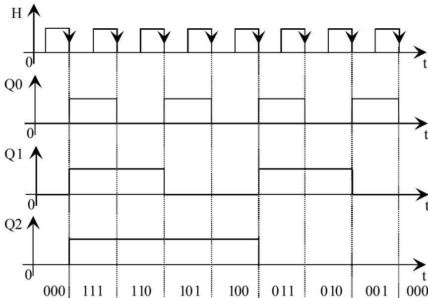
♦ **Compteurs / Décompteurs asynchrones modulo  $2^n$**  (Exemple: compteur / décompteur asynchrone modulo  $2^3 = 8$ ).
