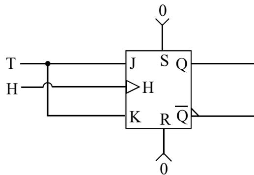
La bascule T est en fait un cas particulier de la bascule JK. Elle s'obtient en connectant ensemble J et K. Elle est utilisable uniquement en mode synchronisé. Lorsque T vaut 1 sur un front montant de H nous inversons l'état des sorties. Si nous bloquons T à 1 nous obtenons un diviseur de fréquence.
