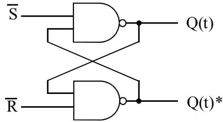
d'où :  $Q(t)^+ = \overline{\overline{S} \cdot Q(t)^*}$  et  $Q(t)^* = \overline{\overline{R} \cdot Q(t)}$
