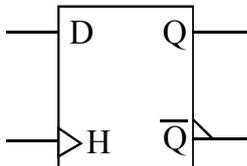
Basculer D à commande par front montant
