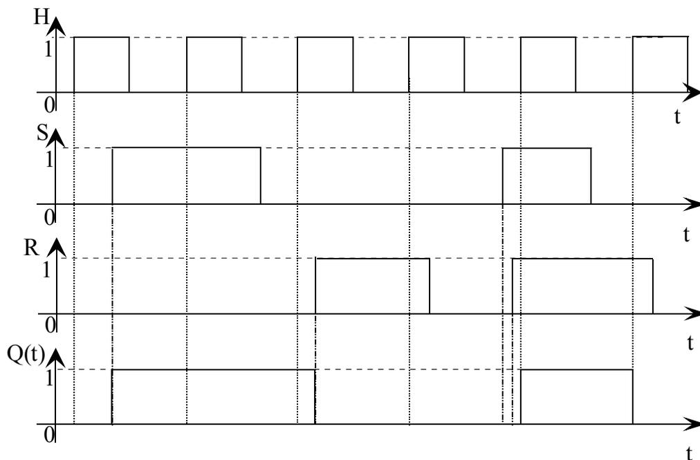
Il existe deux types de bascules : des bascules recopiant l'état de R et de S sur niveau de l'entrée d'horloge H (ci-dessus) et des bascules recopiant l'état de R et de S sur le front montant ou descendant de l'entrée d'horloge H (ci-dessous).
