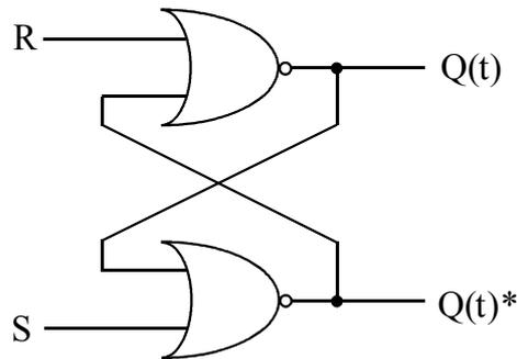
d'où :  $Q(t)^+ = \overline{R + Q(t)^*}$  et  $Q(t)^* = \overline{S + Q(t)}$
