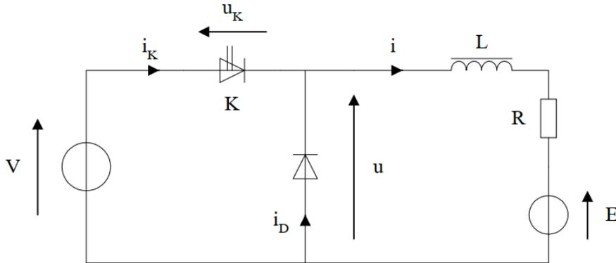
Le hacheur fonctionne à une fréquence  $f = 500$  Hz.
