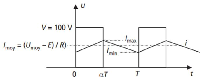
6) L'ondulation de courant s'écrit :  $\Delta i = I_{\max} - I_{\min}$
