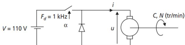
Les caractéristiques de la machine sont : résistance de l'induit  $R = 0,5 \Omega$ , inductance d'induit  $L = 13,7$  mH, courant d'induit nominal :  $I_n = 17$  A, tension nominale :  $U_n = 100$  V
