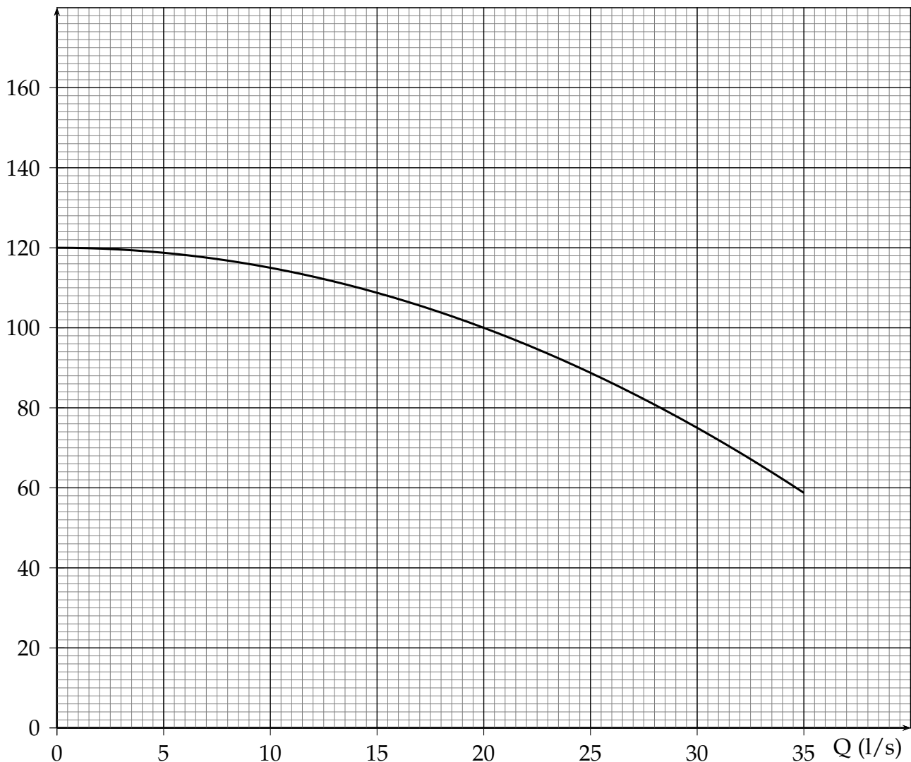
FIGURE 2.62 Courbe de la pompe de l'application de l'exercice [E19] ( N = 1450 tr/min).
