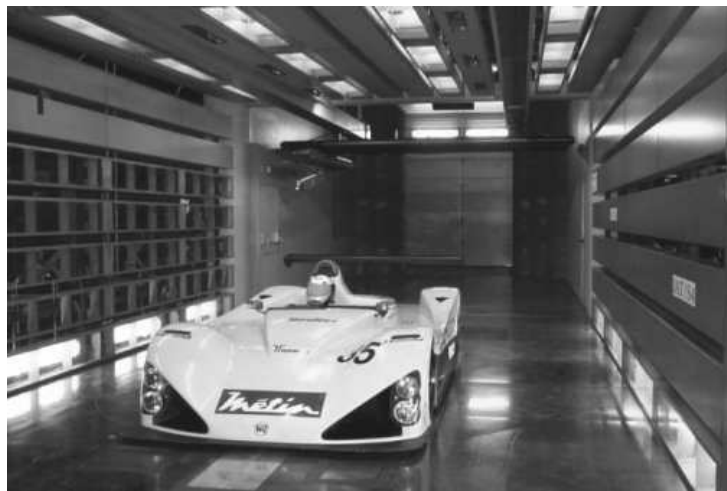
FIGURE 5.38 Étude aérodynamique d'une voiture de compétition. Photo de la soufflerie S4 de l'Institut AéroTechnique du CNAM (Une balance à 6 composantes, est disposée sous le plancher de la chambre d'expériences. Le véhicule à qualifier repose sur ses roues, sur quatre patins de forme rectangulaire affleurant le plancher et liés au bâti mobile de la balance. Trois dynamomètres à jauges de contraintes, dont les axes de mesure sont dirigés perpendiculairement au plancher, transmettent les poussées verticales à des butées hydrostatiques. Trois autres dynamomètres répartis dans un même plan horizontal et orientés suivant des directions orthogonales privilégiées, sont utilisés pour déterminer les composantes horizontales du torseur des efforts.).
