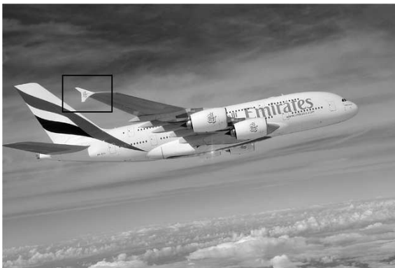
FIGURE 5.10 a, ailette marginale en bout d'aile d'un A380 (Airbus S.A.S. 2008 - Photo exm company / H. Goussé) ; b, ailette marginale testée en soufflerie (d'après Whitcomb [55]).
