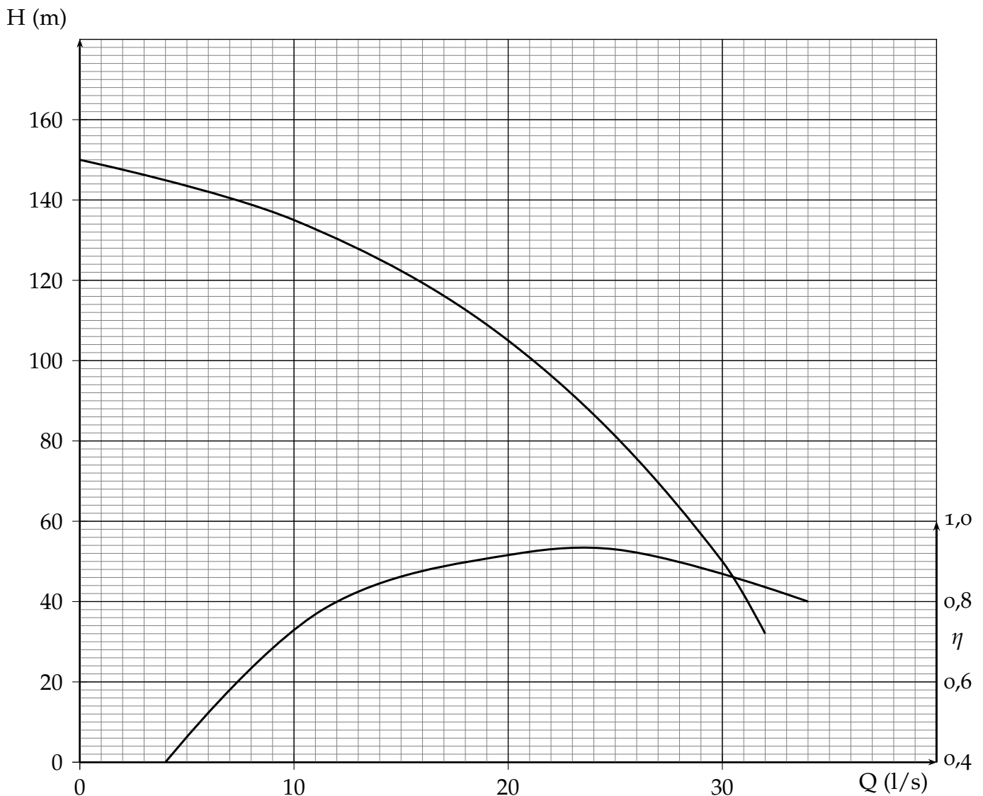
FIGURE 3.29 Courbes de la pompe de l'application de l'exercice [E28] ( N = 1450 tr/min).
