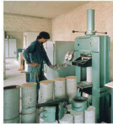
Fig. 1.5 : Ecrasement d'éprouvettes de béton avec une presse hydraulique
