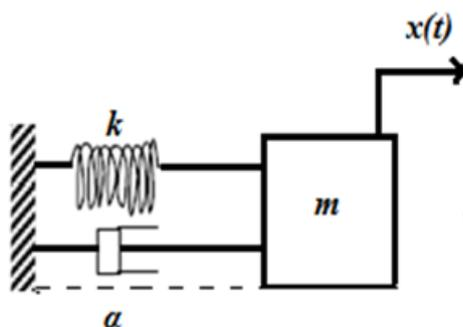
Figure II.2 Exemple d'un système masse-ressort-amortisseur
