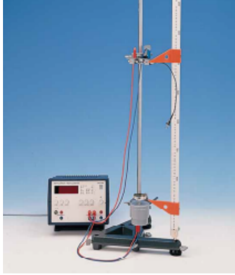
الشكل (2-1) : التركيب المستعمل في تجربة السقوط الحر
