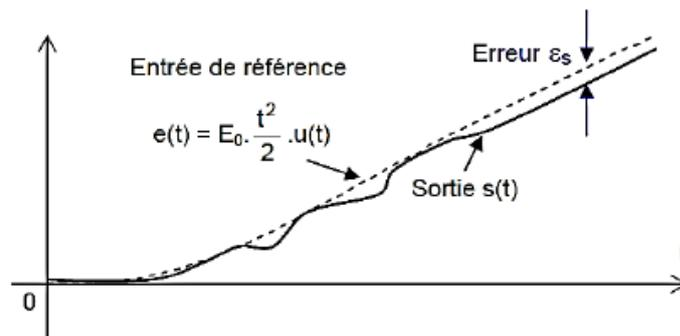
erreur statique pour une entrée parabole
