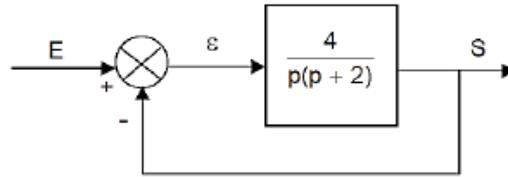
Calculons ses différentes erreurs statiques pour des entrées en échelon, rampe et parabole. Tout d'abord assurons-nous de la stabilité du système, pour cela, nous utiliserons le critère de Routh :
