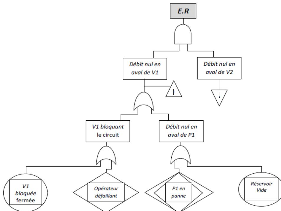
Figure 2.1 Exemple d'un arbre de défaillance [12]
