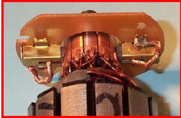
Le collecteur est constitué par une juxtaposition cylindrique de **lames de cuivre séparées par des lames isolantes**. Chaque lame du collecteur est **reliée électriquement à un ou plusieurs conducteurs de l'induit**.
