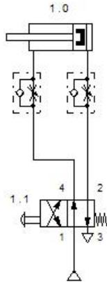
Agissant sur l'alimentation, des étranglements permettent un réglage séparé sur l'avance et sur le retour. Démarrage doux mais possibilité de réglage moins bonne. Cette solution ne peut pas être utilisée pour la traction des charges. Elle s'emploie sur les vérins de petit volume qui fonctionnent en poussant la charge
