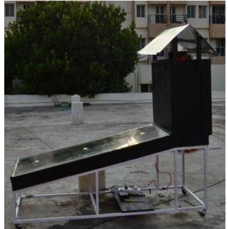
Fig 3. Séchoir solaire indirect
