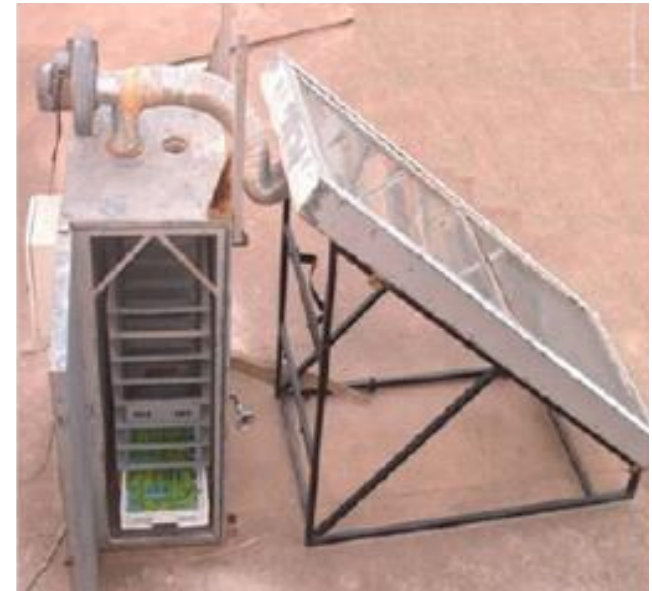
Fig. 4 : Séchoir solaire hybride
