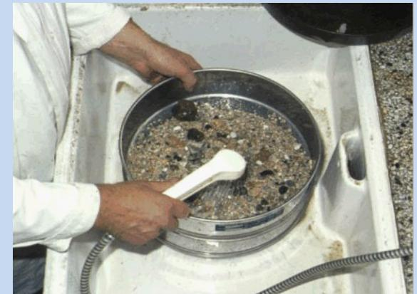
Le matériau étudié est placé en partie supérieure des tamis et le classement des grains s'obtient par vibration de la colonne de tamis et après lavage des grains pour éliminer la poussière .
