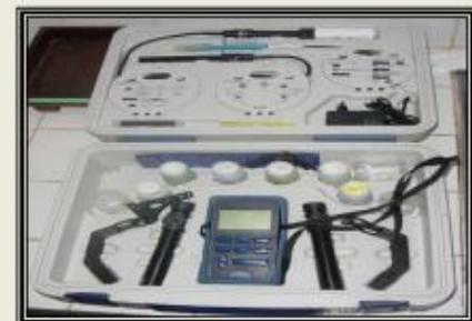
Analyseur multi paramètres de terrain
