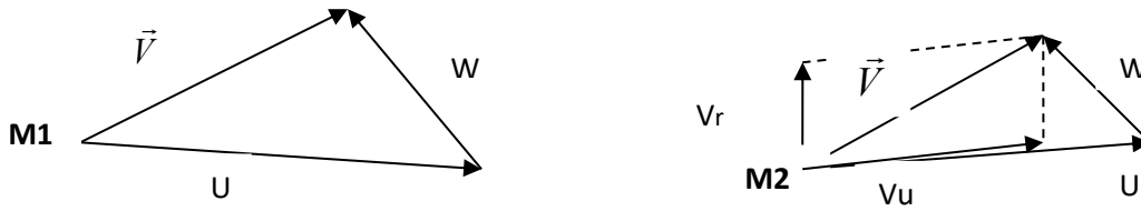
Fig. 3 : Les triangles des vitesses
